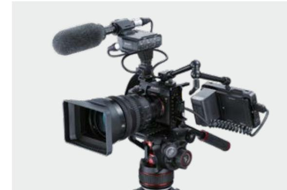
新開発フルサイズイメージセンサーと新画像処理エンジン「BIONZ XR」の搭載で、画素加算のないフルサイズ領域での4K全画素読み出しのほか、10bitのビット深度、4:2:2カラーサンプリング、高効率なMPEG-H HEVC/H.265コーデック対応、All-Intra記録\*12など高い映像品質を実現。また、最大120pのハイフレームレート動画を4K解像度によるカメラ内記録に対応。4K解像度で最大5倍のなめらかなスローモーションで印象的な映像表現が可能になりました。拡大するRAW収録への要望に応え、αシリーズ初\*10、カメラからHDMIケーブル経由で対応する外部レコーダー\*13への16bit RAW動画の出力が可能に。ポストプロダクションを前提としたワークフローを高い基本性能でパワフルにサポートします。
