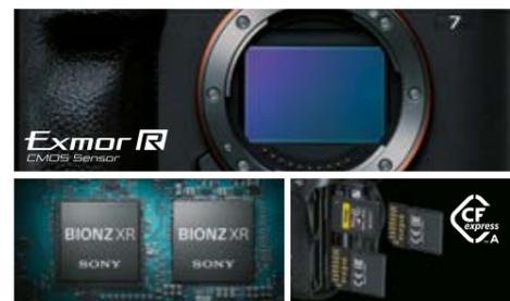
静止画・動画の撮影領域のさらなる拡大を目指し、ソニーが誇るイメージセンサー技術を結集し、裏面照射型 有効約3300万画素の35mmフルサイズCMOSセンサーを開発。また、ベーシックモデルでありながら、フラッグシップモデルのα1やα7S IIIで採用された最新の画像処理エンジン BIONZ XR (ピオンズ エックスアール) を搭載することで、撮像や各種信号処理の実行まで随所で処理能力が大幅に向上しています。これにより、高い階調表現や忠実な色再現性能などの画質進化、AF/AFおよび顔/瞳検出の速度・精度向上、4K 60pの動画記録などの膨大な映像データ処理、EVF表示やメニュー操作におけるレスポンス向上、CFexpress Type Aメモリーカードへの高速書き出し性能など、α1やα7S IIIで実現した多くの機能や性能を本機でも引き継いでいます。
